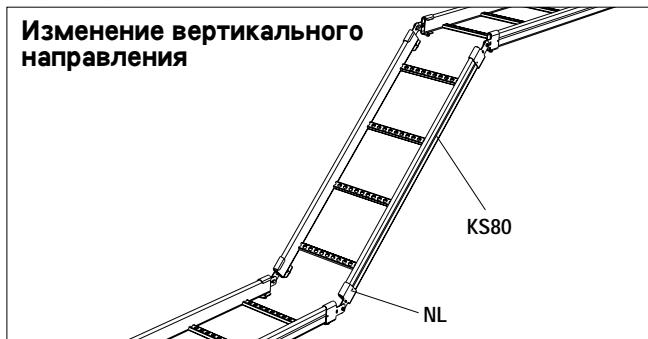
При помощи шарнирного/углового соединения NL/ KS20 может быть как угодно изменен вертикальный угол наклона профильного лотка KS20, и при помощи шарнирного/углового соединения NL может быть как угодно изменен вертикальный угол наклона профильного лотка KS80.
