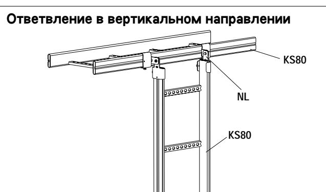
При помощи шарнирного/углового соединения NL или NL/ KS20 ответвление вертикально расположенного элемента можно выполнить под любым углом.
