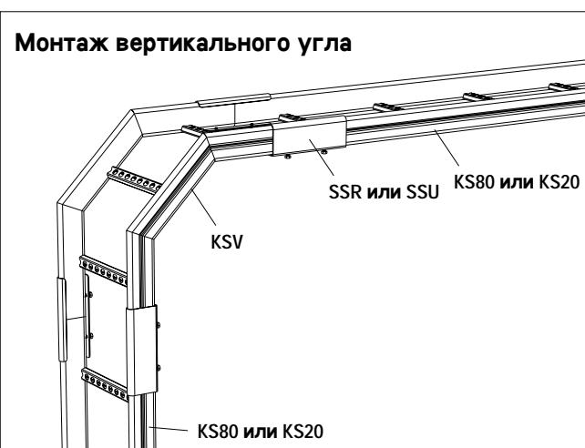
Вертикальный угол KSV крепится к профильному лотку KS20 при помощи удлинительного элемента SSR/ KS20 и к профильному лотку KS80 – при помощи удлинительного элемента SSR или SSU.
