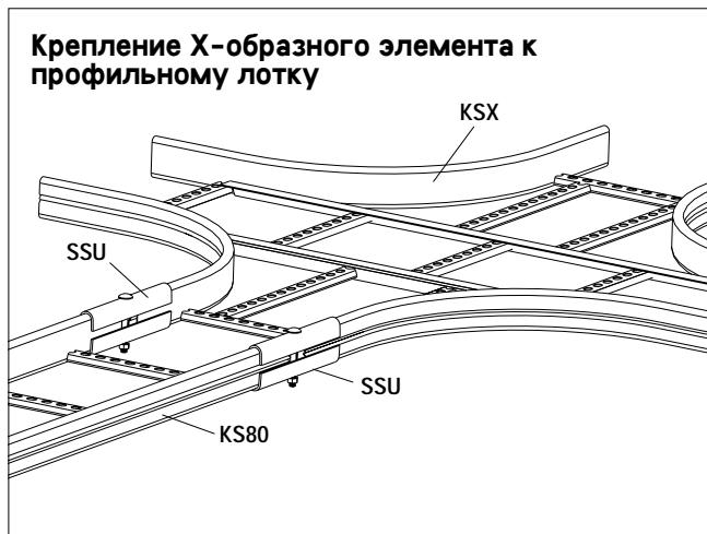
Элемент Х-образный KSX крепится к профильному лотку KS80 при помощи соединительного элемента SSU.
