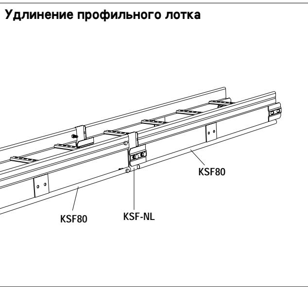
Шарнирное соединение KSF-NL применяется в тех случаях, когда профильный лоток KSF80 удлиняется не от торцевых пластин, а с другого места.
