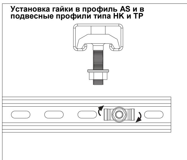
Гайки ТВ устанавливаются в профиль и поворачиваются на 90°. При закреплении следует проверить что гайка ТВ находится в поперечном направлении по отношению к оси профиля.
