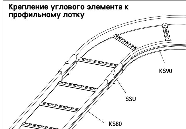
Угловой элемент KS90 крепится к профильному лотку KS80 при помощи соединительного профиля SSU.
