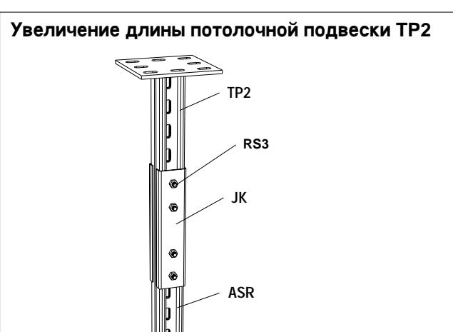
Потолочную подвеску TP2 можно удлинить при помощи опорного профиля ASR и удлинителей JK (2 шт.). При удлинении используется комплект болтов RS3.
