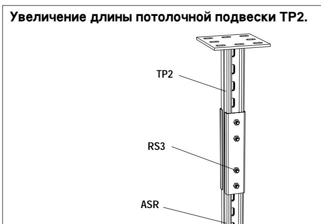
Потолочную подвеску TP2 можно удлинить при помощи опорного профиля ASR и удлинителей JK (2 шт.). При удлинении используется комплект болтов RS3.
