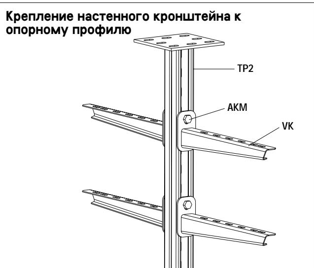
Настенный кронштейн крепится к опорному профилю при помощи гайки опорного профиля АКМ.
