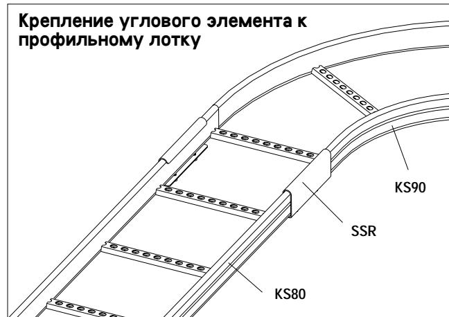
Угловой элемент KS90 крепится к профильному лотку KS20 при помощи соединительного профиля SSR/ KS20 и к профильному лотку KS80 – при помощи соединительного профиля SSR.
