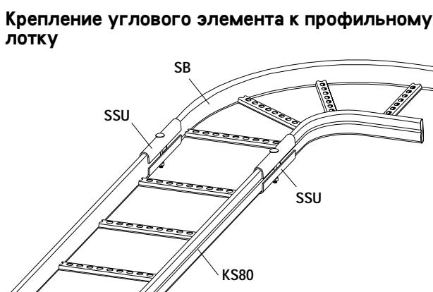
Угловой элемент SB крепится к профильному лотку KS80 при помощи соединительного элемента SSU.
