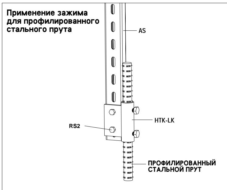
Зажим для профилированного стального прута HTK-LK крепится к подвешенному к потолку или к прикрепленному к полу профилированному стальному пруту. Опорный профиль AS крепится к профилированному стальному пруту HTK-LK комплектом болтов RS2.
