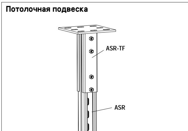
Опора потолочная ASR-TF используется при потолочном и напольном монтаже совместно с опорным профилем ASR.
