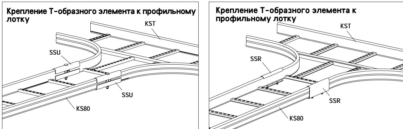
Т-образный элемент KST крепится к профильному лотку KS80 при помощи соединительного элемента SSU.
