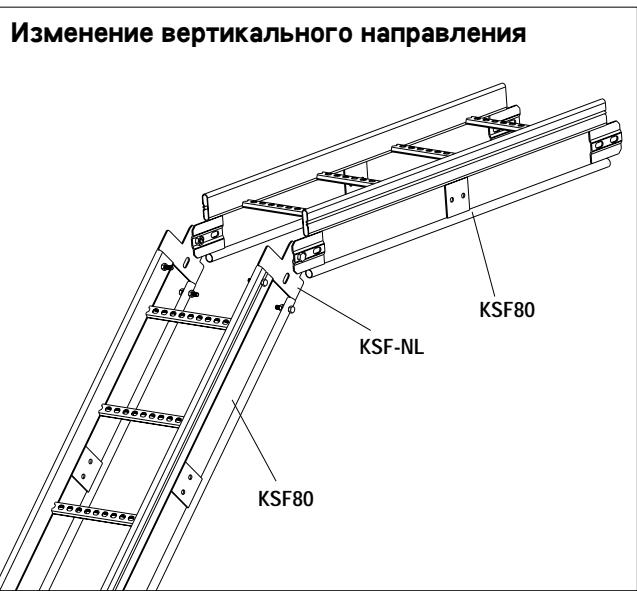
Угол наклона профильного лотка KSF80 может быть изменен как угодно при помощи шарнирного соединения KSF-NL.
