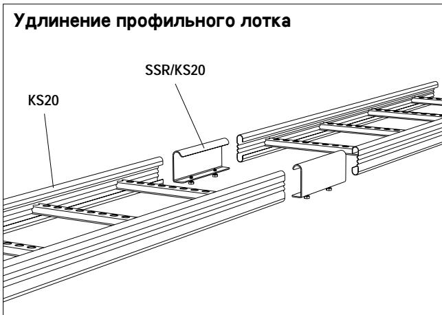
Соединительный профиль SSC/ KS20 используется для удлинения профильного лотка KS20, и соединительный профиль SSR – для удлинения профильного лотка KS80.
