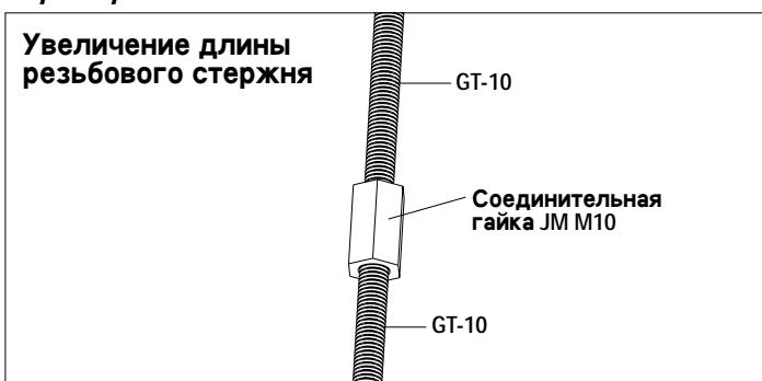
Длина резьбового стержня GT может быть увеличена при помощи соединительной гайки.
