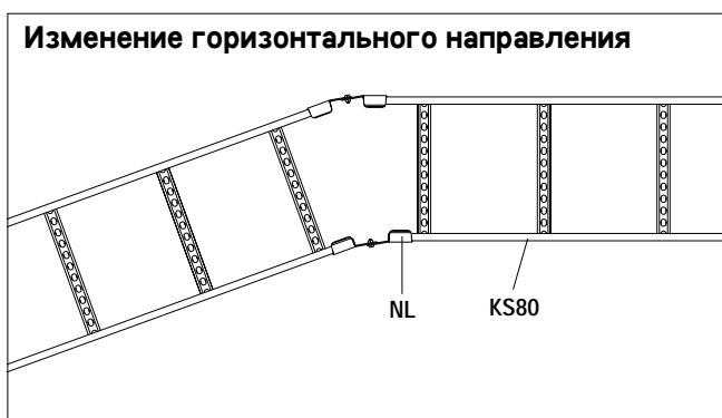
Обрезав боковые профили профильного лотка KS20 или KS80 так, чтобы они были разной длины и используя шарнирное/угловое соединение NL или NL/ KS20, можно сделать изменение в горизонтальном направлении профильного лотка.
