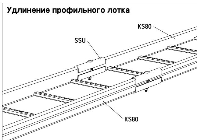
Соединительный профиль SSU используется для удлинения профильного лотка KS80.
