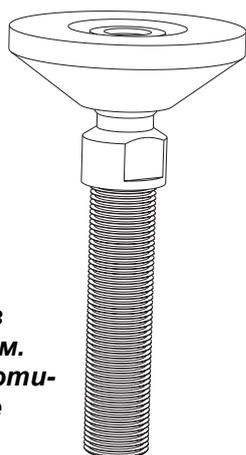
Регулировка в пределах 50 мм.
