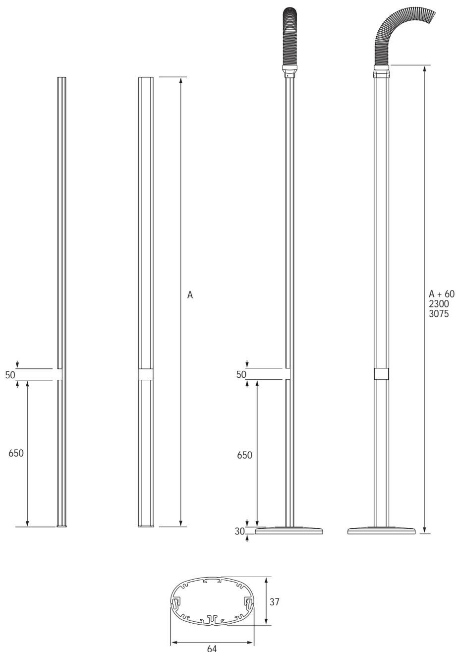
Стандартные длины INSTAL SP P сервисных стоек составляют 2240 мм и 3015 мм (A). Стандартная высота для вывода кабеля из сервисной стойки от основания стойки составляет 650 мм. Мы также предлагаем поставки изделий с другой длиной. Стандартными цветами являются белый RAL 9010 и серый RAL 9006. Другие цвета возможны на основе запроса.
